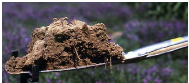
Die Spatenprobe erfordert wenig Aufwand und liefert in kurzer Zeit wertvolle Hinweise zum physikalischen Zustand des Bodens.
