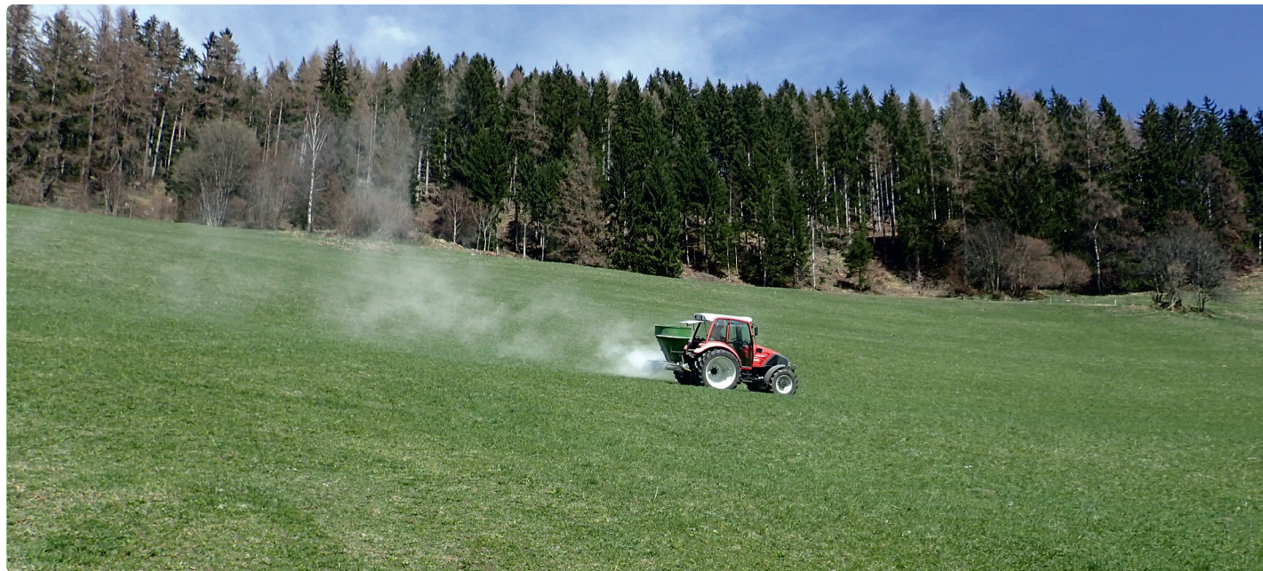
Granuliertes Kalkkorn mit Tellerstreuer am Hang.
