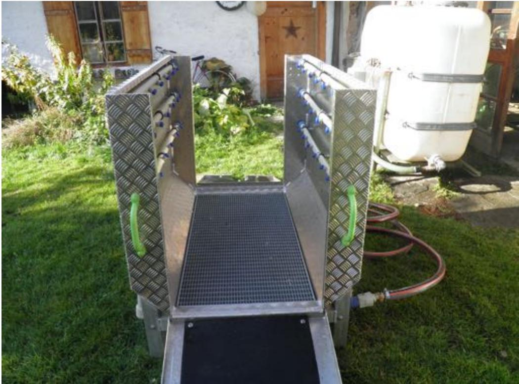
Hier mit aufgeklappter Vorder- und Rückwand. Auf drei Ebenen sind Waschdüsen angebracht.
