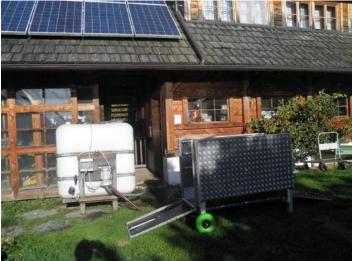
Die beschriebene Waschanlage mit klappbarer Vorder- und Rückwand. Das abfließende Wasser kann mittels Kanalrohranschluss abgeleitet werden.
