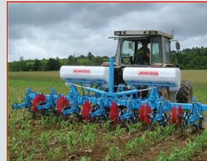
Hackmaschine SCD für Rüben, Mais, Kürbis, usw. Es sind verschiedene Modelle von Düngerstreuer verfügbar. Fronthackmaschine wahlweise mit gezogenen oder geschobenen Hackelementen. Hackelemente sind mit Pflanzenschutzblechen oder Pflanzenschutzscheiben ausrüstbar.
