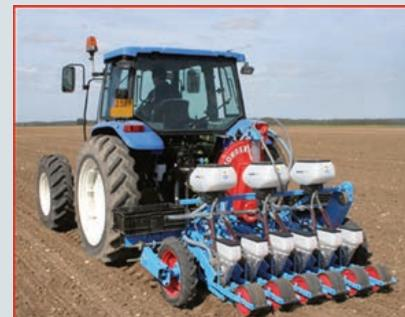
Spezial-Einzelkornsämaschine für Kleinsämereien im Gemüsebau. Sie steht für Bedienungsfreundlichkeit, Sicherheit, Genauigkeit, Stabilität, Zuverlässigkeit – für eine perfekte Aussaat von Möhren, Rettich, Endivien, Petersilie, Porree, Zwiebeln, Kohl, usw...
