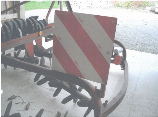
Mit dem Formrohrstecksystem in Sekunden an- und abmontiert, völlig ohne Werkzeug
