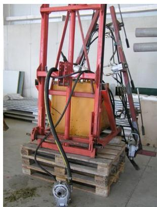
Spätverunkrautungsmähgerät mit hydraulischem Antrieb
