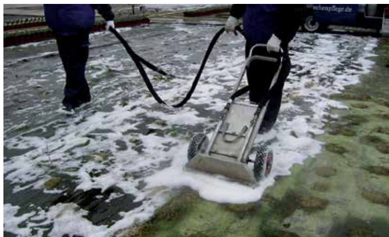
Das neuartige Heißwasserschium-Verfahren dient der Unkrautregulierung und der Flächenreinigung. Bei dem zweistufigen Verfahren wird zuerst 95 °C heißes Wasser ausgebracht und darüber ein natürlicher, vollständig abbaubarer Schaum gelegt, der die Wirkungsdauer des heißen Wassers verlängert, indem er dessen Abkühlung verzögert.
