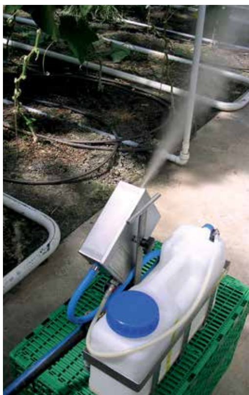
Kaltnebelgeräte sind stationär platziert und erfordern den Einsatz von Ventilatoren, um eine gute Verteilung zu gewährleisten.
