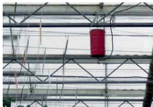
Schwefel kann in speziellen Elektrogeräten (Schwefellampen) verdampft werden.
