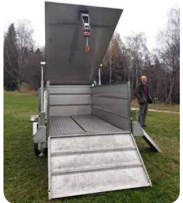
Maximale Zughöhe 3,8 m, Seilwinde betrieben mit Benzinmotor.
