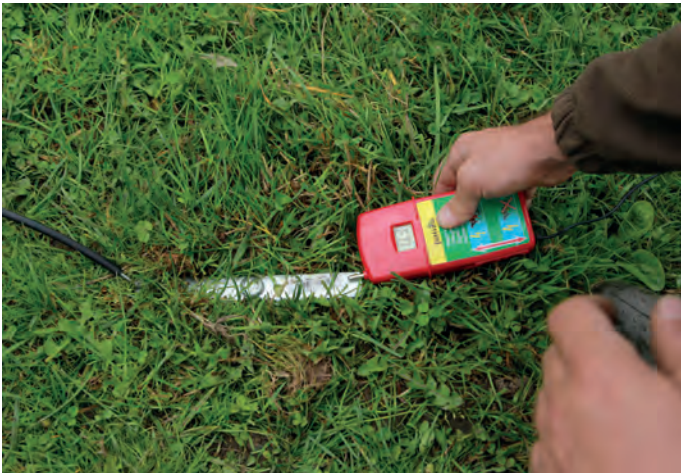
Bei Kurzschluss des Zauns dürfen an der Erdungsanlage höchstens 600 Volt messbar sein.
