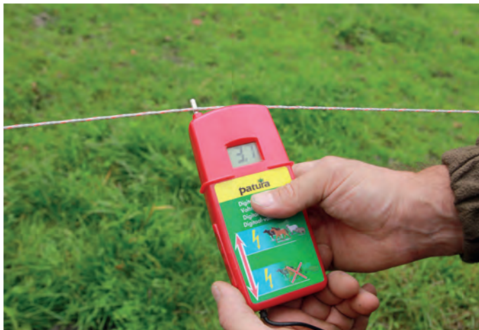
Zaunspannung mit simulierter Tierberührung
