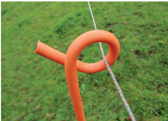
Funkenbildung durch Umwickeln am Isolator
