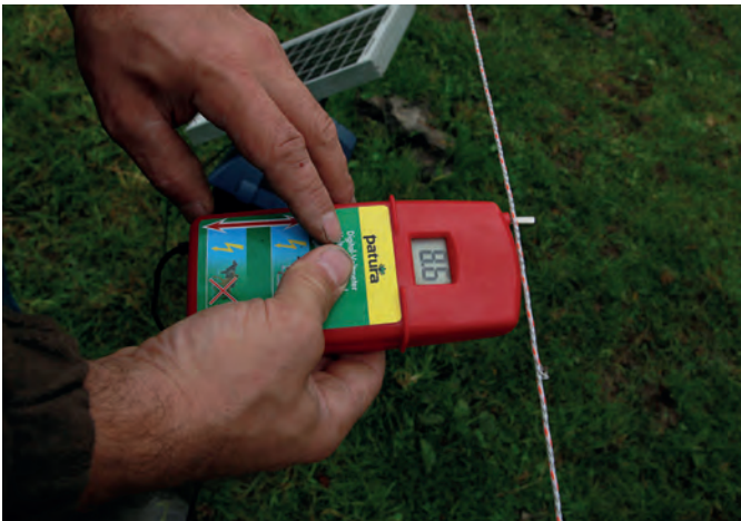
Zaunspannung ohne simulierter Tierberührung
